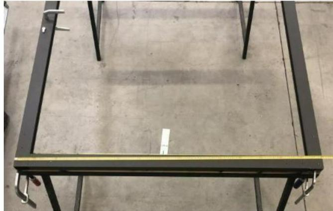
Après avoir prémonté les coins en bas à gauche et à droite, il convient de vérifier la précision des dimensions. Ensuite, les planches WPC sont encastrées étape par étape dans le profilé du cadre. Il faut faire attention à la direction des encoches des planches supérieures et inférieures.
