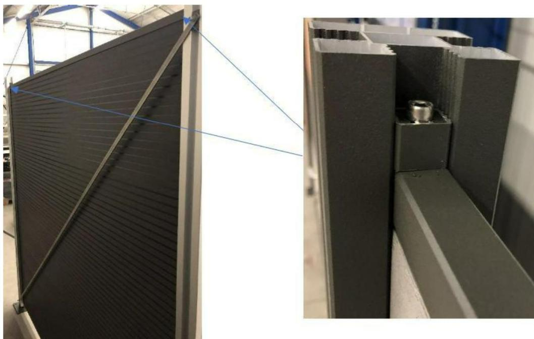
Des raccords diagonaux doivent être placés de haut en bas entre le poteau de portail et les poteaux de clôture voisins. Il s'agit d'un profilé avec des coulisseaux prémontés qui peuvent être enserrés dans les rainures du poteau de portail et du poteau de clôture. Les entretoises longitudinales et transversales sont nécessaires pour toutes les variantes. Le montage des raidisseurs diagonaux est présenté en détail dans une vidéo d'instructions sur [woodstore24.fr](http://woodstore24.fr).
