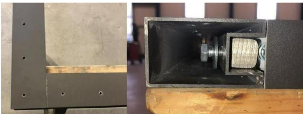
Des raccords d'angle sont prémontés des deux côtés du profilé inférieur. Le raccord d'angle doit être inséré dans la rainure du profilé à gauche comme indiqué. Le coin inférieur gauche peut être entièrement vissé à l'aide de la vis à six pans M8. La vis doit d'abord être serrée à la main afin que l'angle et la précision dimensionnelle puissent être ajustés ultérieurement. Procéder de la même manière avec le coin en bas à droite.
