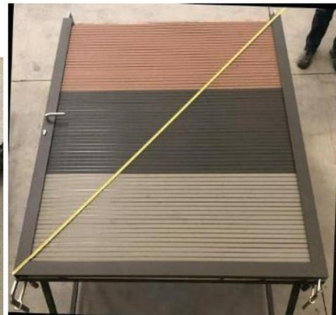
Lorsque les planches sont entièrement encastrées, il convient de mesurer une nouvelle fois le cadre en diagonale. Le profilé peut maintenant être monté en haut et les raccords d'angle peuvent être serrés.
